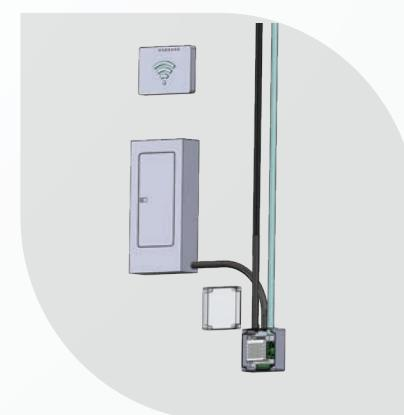
\*Hasta 4 contenedores en máximo 70 mts. de cableado. En caso de necesitar más contenedores o una distancia de cableado mayor, será necesario instalar una fuente de poder adicional.
